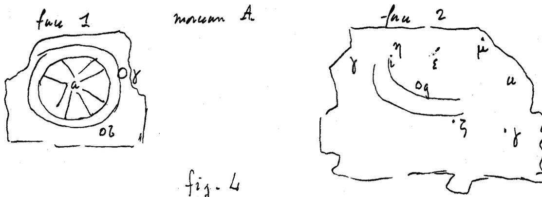
0 m. 025 et 0 m. 020, dont une dans une autre petite roue dentée qui n'est pas donnée sur la figure 3, autour du point central λ, sous le cercle avec les bords dentés, et la deuxième accroche une autre petite roue dont l'axe est encore à peine visible au point ρ. En υ on distingue la trace d'un rivet qui tenait les deux plaques ensemble.
