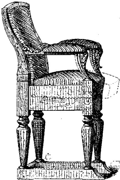
soir, le siège prend la position 2 par suite de l'effet du plan incliné et de son amovibilité. Ce plan incliné étant à faible pente, une légère pression suffit à faire rentrer le siège qui peut également basculer à volonté et très aisément.
